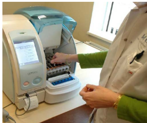
5 - установка штатива в прибор
